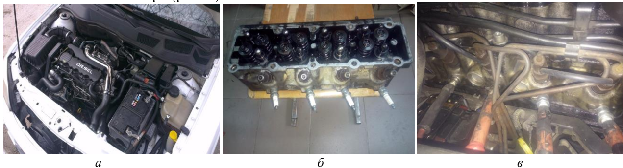
Рисунок 1 - Автомобіль Опель Астра конвертований з дизельного палива на пропан-бутанову суміш: а – дизельний двигун моделі X17DTL; б – головка блока переобладнаного двигуна; в – встановлена на переобладнаний двигун головка блока з системою запалення
