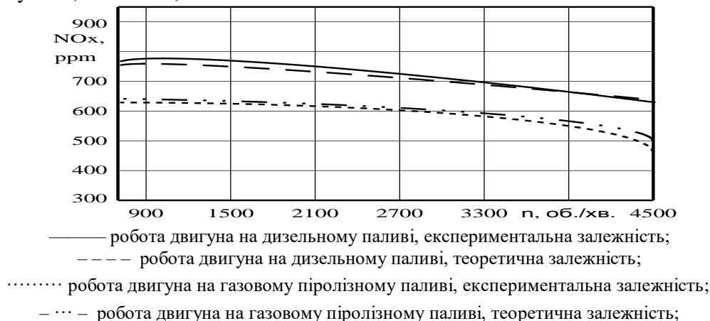
Рисунок 2 – Залежності викидів оксидів азоту у відпрацьованих газах дизельного двигуна моделі X17DTL автомобіля Опель Астра при роботі на дизельному паливі та при роботі на піролізній суміші в залежності від частоти обертання колінчастого вала n
