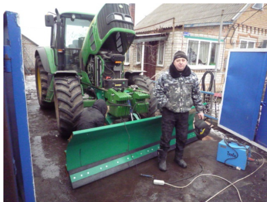
Рисунок 9 – Процес установки універсального для фермерського господарства бульдозерного робочого обладнання доц. Карпушиним С.О. в с. Тарасівка Новгородківського району Кіровоградської області
