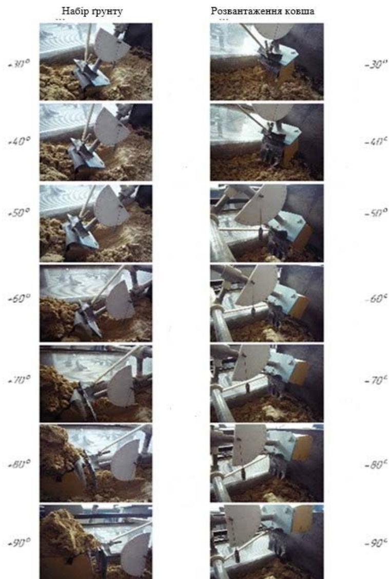
Рисунок 6 – Фотограма завершальних етапів заповнення ковша (кут +30...90°) і вивантаження ковша (кут – 30...90°) на модельованому ґрунті I категорії з вологістю W=16-18\% .
