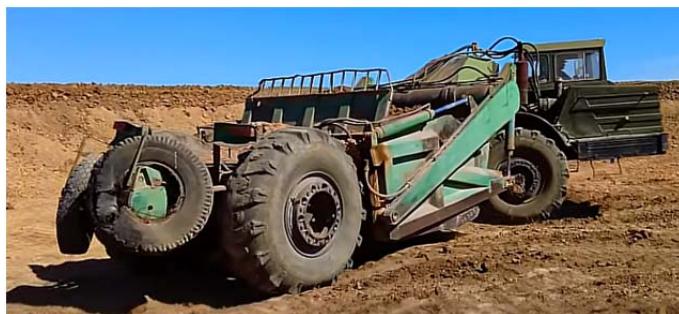
Рисунок 1 – Застосування відпрацьованих автомобільних покришок на буфері самохідного скрепера МоАЗ-6014, м. Берегово Закарпатська обл. 2021р.
