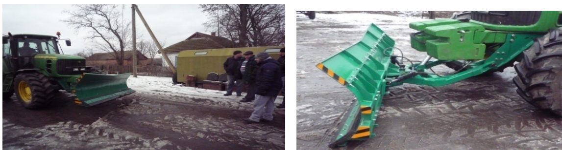
Рисунок 11 – Загальний вигляд колісного трактора John Deere 6930 з пропонованим універсальним бульдозерним робочим обладнанням під час натурних випробувань
