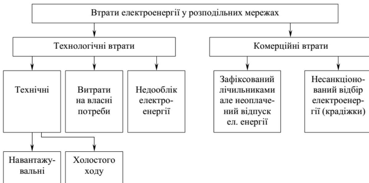
Рис. 1.2. Структура втрат у розподільчих мережах [25].
