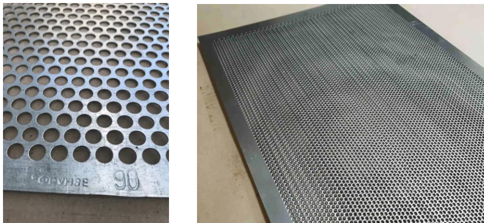
Рис 2.4. Плоскі решета з круглими отворами
