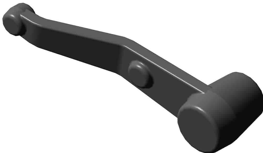
Рисунок 1.3 – Параметрична тривимірна твердотільна модель поковки "Важіль"
