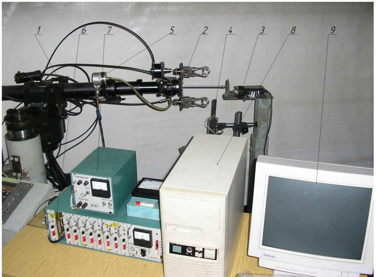
Рисунок 3.4 – Експериментальна установка для дослідження динамічної якості двозахватних пристроїв промислових роботів:
