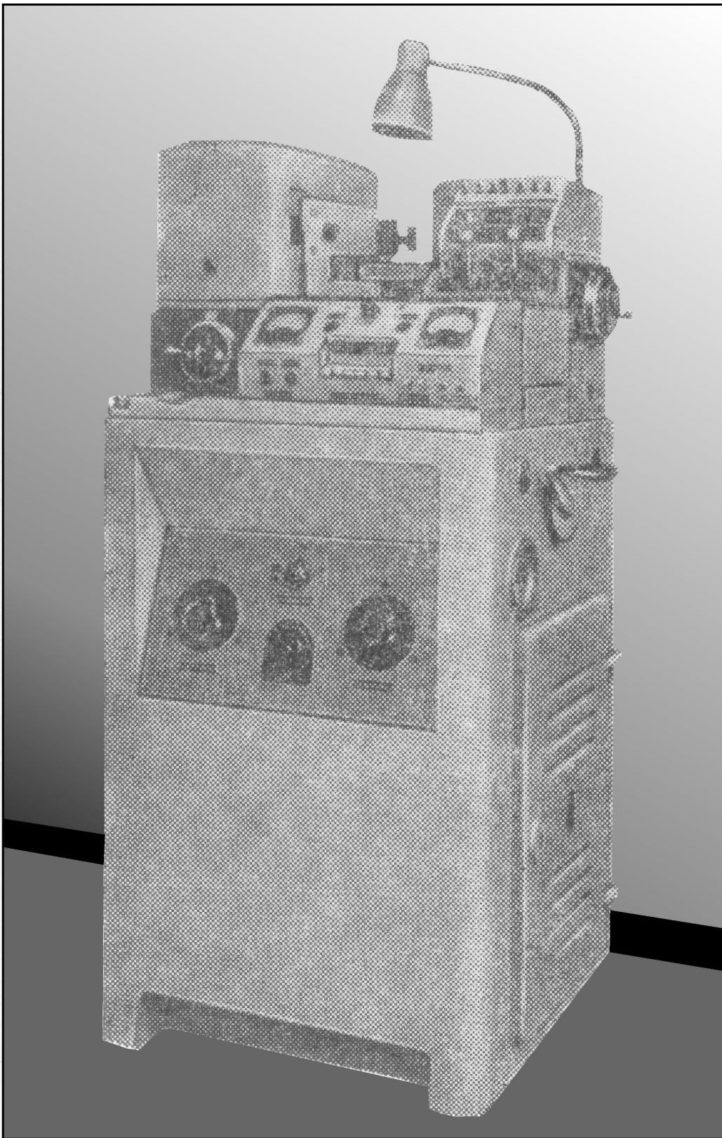
Рис. 1.3. Електроерозійний верстат моделі 4531 для профільного вирізування деталей електродом-дротом
