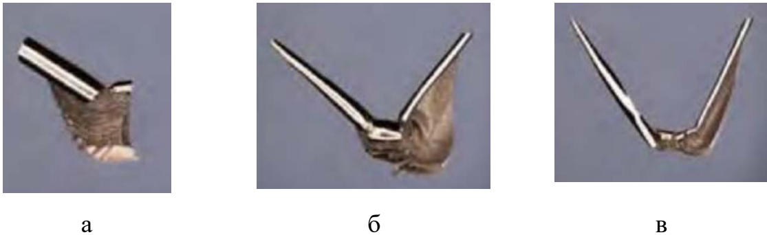
Рис. 3.7 Форма стружки при зуботочінні: а- перший чорновий прохід; б- другий чорновий прохід; в- фінішний прохід.
