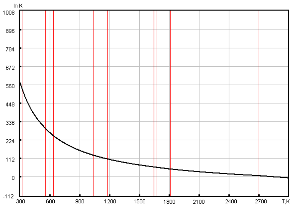
Рисунок 3.10 – Залежність \ln K_p реакції 2[P] + 5(FeO) = (P_2O_5) + 5Fe від температури
