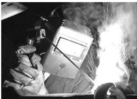
Рисунок 18 - Схема ручного дугового зварювання покритим електродом
