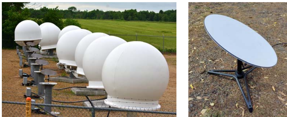
Рисунок 4 – Зовнішній вигляд наземного шлюзу та абонентського терміналу Starlink
