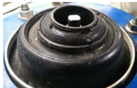
Рисунок 1 – Опори з пошкодженим гумовим елементом
