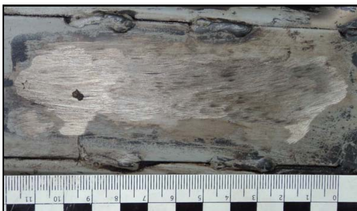
Рисунок 2 – Знищений VIN-номер шляхом видалення абразивом верхнього шару металу
