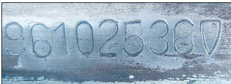
Рисунок 6 – Результат застосування методу електрохімічного травлення
