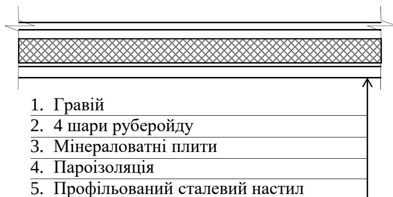
Рис. 1.2 - Конструкція покриття
