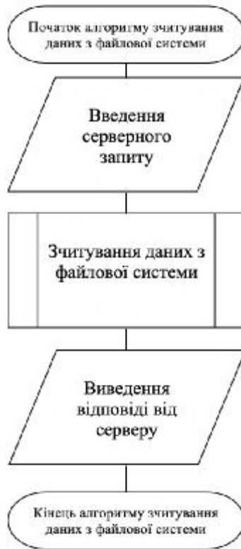
Рисунок 4.9 – Блок-схема алгоритму зчитування відповіді на запит з файлу у випадку втрати зв'язку інтернетом
