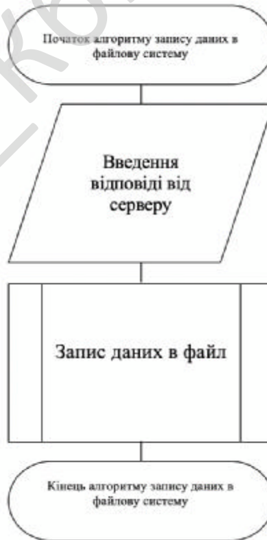
Рисунок 4.10 – Блок-схема алгоритму запису серверної відповіді в файл
