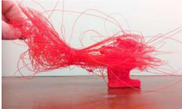
Рисунок 5.4 - Деформація виробу під час друку
