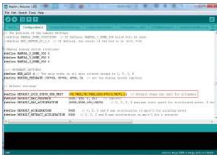
Рисунок 5.1 - Калібрування осей 3D-принтера
