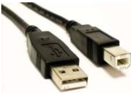
Рисунок 3.4 - З'єднувальний кабель Arduino Mega - PC
