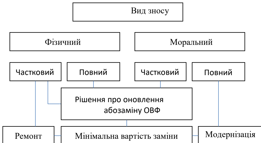
Рис.3.6. Взаємозв'язок зносу ОВФ та прийняття рішення відносно його заміни
