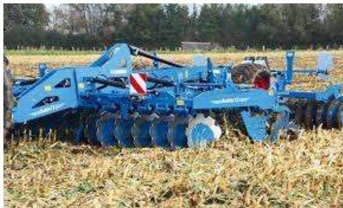
Рис. 1.2. Загальний вигляд дискової борони для основаного обробітку
