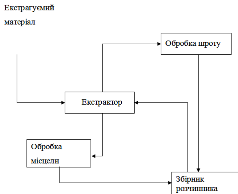
Рисунок 1.1 – Загальна схема екстракційного процесу
