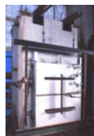
Рисунок 2.13 - Випробувальний стенд для тестування фрагментів фасадних систем
