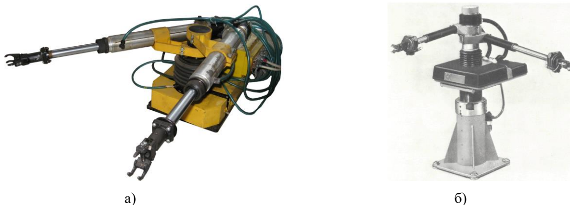
Рисунок 1 – Промислові роботи, що мають дві руки: а – промисловий робот РФ-202М; б – промисловий робот Electrolux MNU Junior 305
