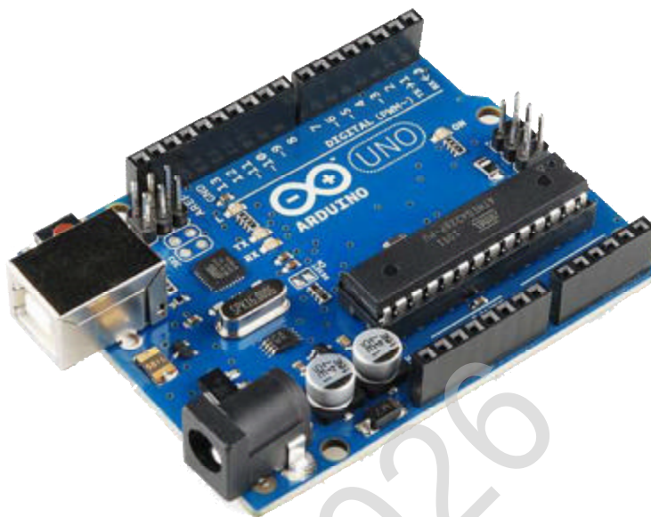
Рисунок 2.8 – Апаратна платформа Arduino UNO
