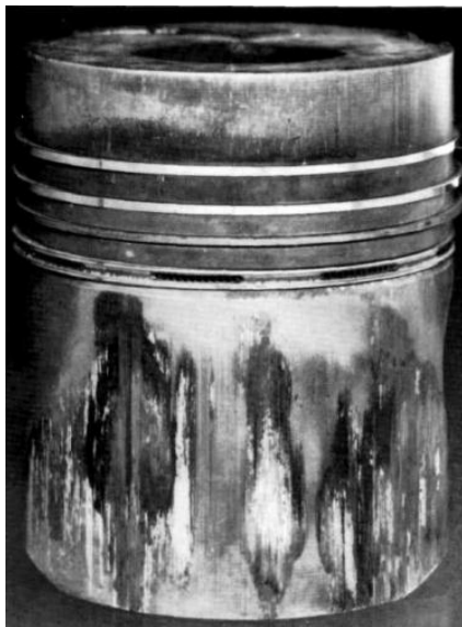
Рис.2.1 Поршень із дефектом – Зайдання зазору
