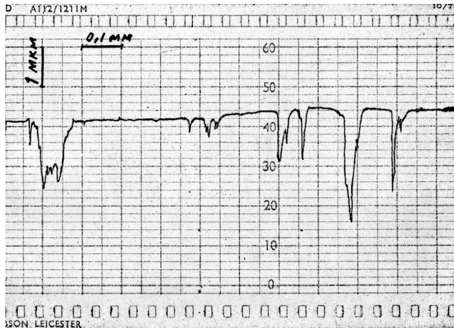
Рис.3.9. Профілограма робочої поверхні гільзи після використання комплексної технології після припрацювання
