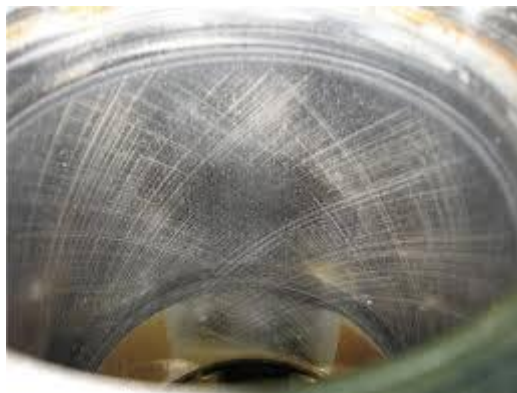
Рис.2.5. Знос внутрішньої поверхні гільзи в наслідок абразивного зношування.
