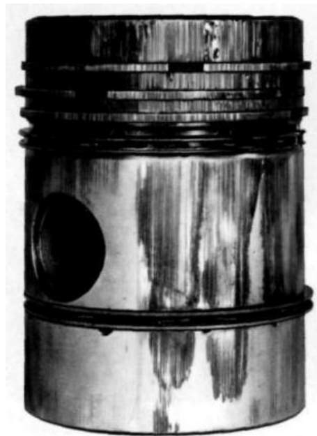
Рис.2.3. Поршень із дефектом – Комбінація заїдання під час роботи без змащення і заїдання зазору
