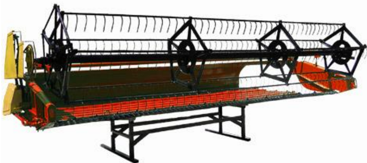
Рисунок 3.4 – Жатка валкова навісна ЖВН-6Б
