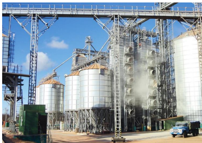
Рис. 1.3 - Високопродуктивні зернові сушарки шахтного типу безперервної дії
