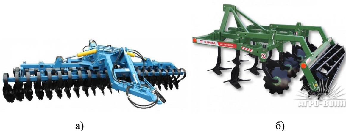
Рис. 2.1. Дисковий луцильник ЛДВП-3,5 (а), культиватор-плоскоріз SIPMA AU DZIK (б)
