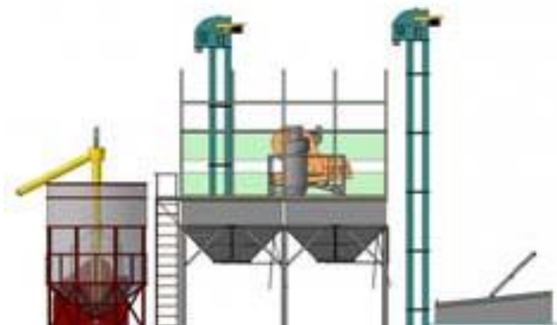
Рис. 2.3. Зерноочисний комплекс ЗАВ-100 (а), зерносушильний комплекс КЗС (б)
