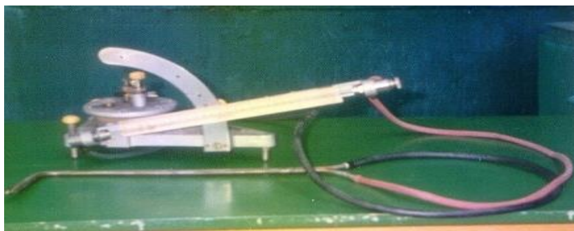
Рис. 3.5. Загальний вигляд мікроманометра ММН-1 з пневмометричною трубкою
