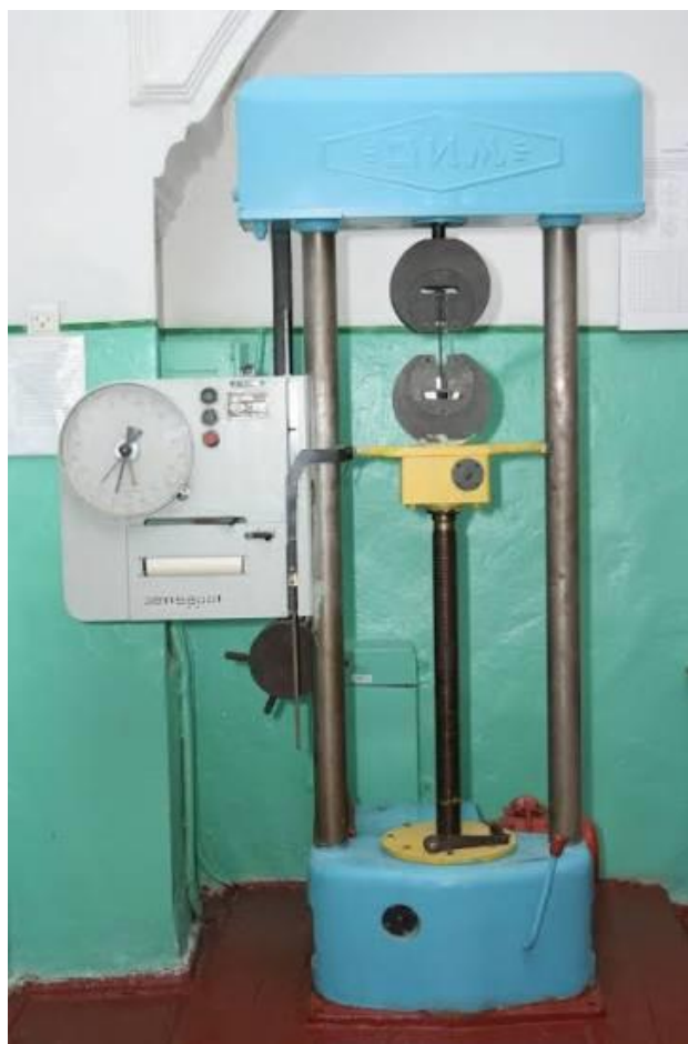
Рисунок 2.7 – Універсальна випробувальна машина для випробувань на розтяг
