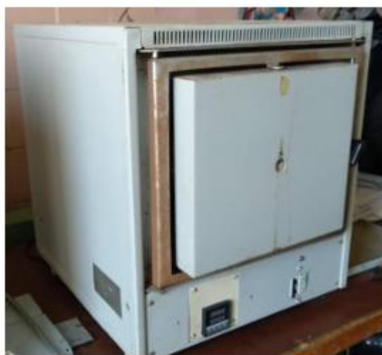
Рисунок 2.2 – Камерна електрична піч для проведення термічної обробки дослідних зразків
