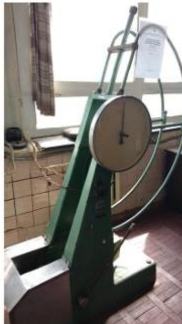
Рисунок 2.8 – Маятниковий копр для визначення ударної в'язкості.
