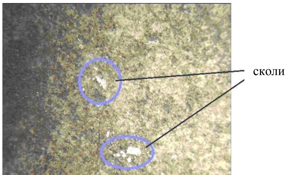
Рисунок 4.3 - Сколи на модифікованому частинками нанопорошку \text{CuO} МДО покритті, що утворюються при експлуатації відновленої та зміцненої деталі \times 25
