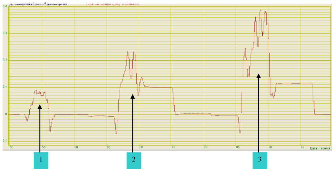
Рисунок 4.5 – Графік зміни загального коефіцієнта тертя для пари тертя «сталь 40X – МДО покриття» залежно від навантаження, де результати вимірювань відповідають: 1 – при 125 Н; 2- при 240 Н; 3 - 340 Н
