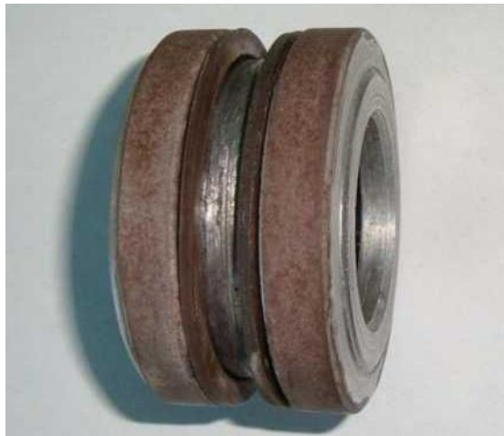
Рисунок 4.13 – Поршень гідроциліндра ГЦ-75.30.200.000.25 відновлений та зміцнений за рахунок застосування комбінованої технології МДО з подальшим модифікуванням МДО покриття частинками нанопорошку \text{CuO} .
