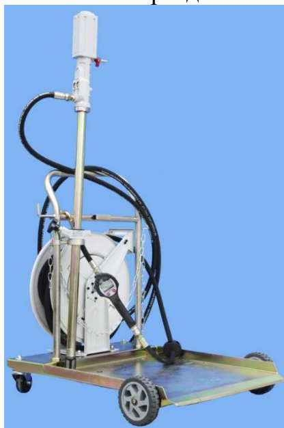
Рисунок 4.3 - Установка оливороздавальна з ручним приводом без резервуару.
