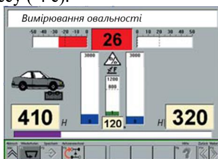
Рисунок 5.13– Зображення монітора при овальності гальмівних дисків чи барабанів.
