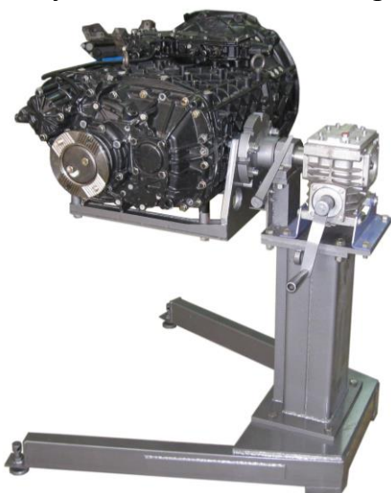
Рисунок 7.12 - Стенд для розбирання коробки передач.
