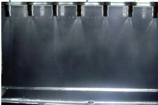
Рисунок 5.45 - Перевірка якості розпилювання.
