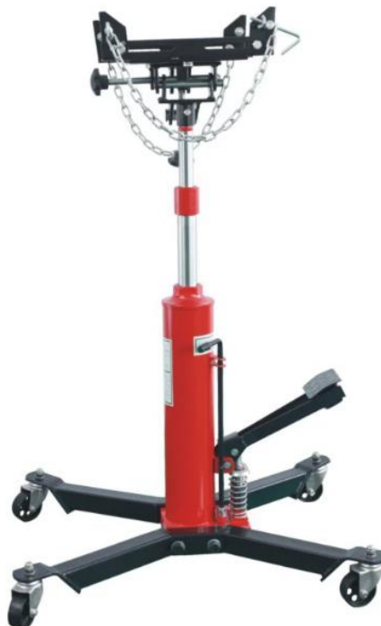
Рисунок 3.29 - Пересувний трансмісійний телескопічний домкрат
