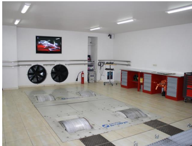
Рисунок 5.2 - Динамометричний стенд з одинарними біговими барабанами.
