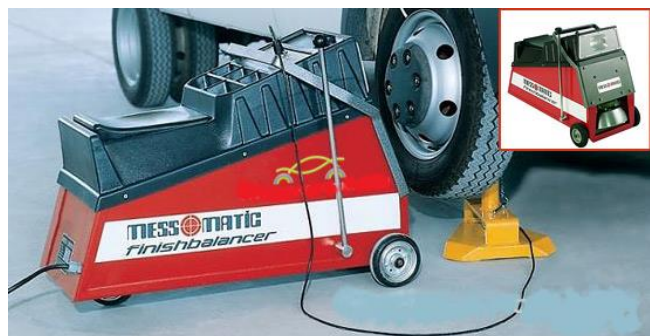
Рисунок 6.14 - Загальний вигляд станда балансування коліс на автомобілі.
