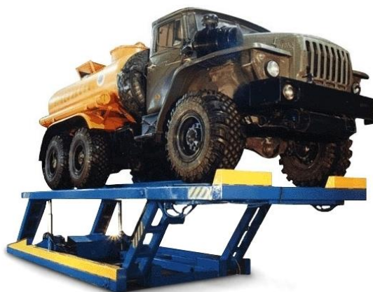
Рисунок 3.14 - Гідравлічний підйомник паралелограмного типу.
