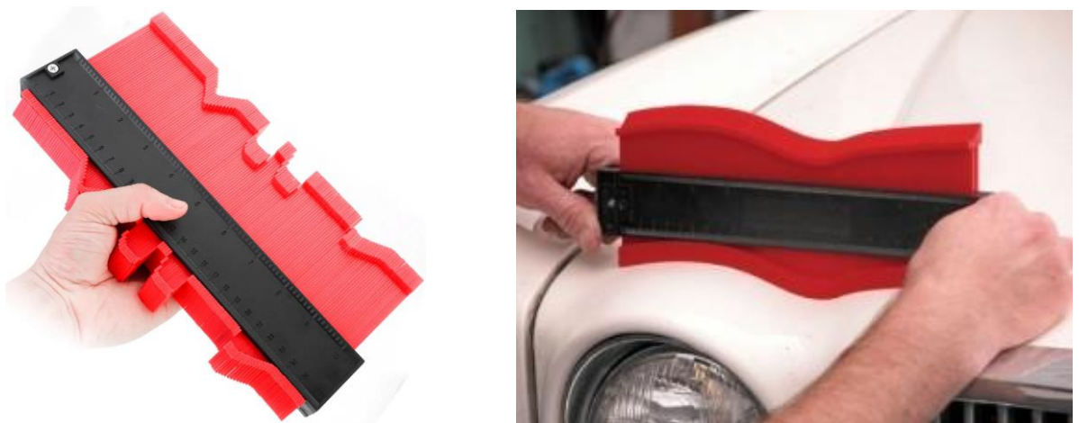
Рисунок 8.3 - Шаблони для контролю профілю кузовних елементів.
