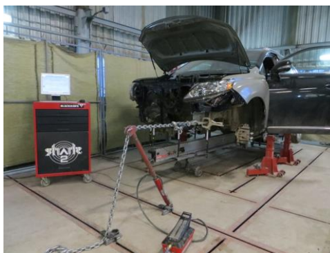
Рисунок 8.7 – Стенд з вимірювальною системою PMS з комбінованою (ультразвуковою й механічною системою вимірювання в прямокутній системі координат) WEDGE CLAMP SYSTEM (Канада).
