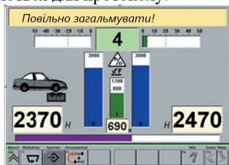
Рисунок 5.14 – Зображення монітора при визначенні максимальної гальмівної сили.
