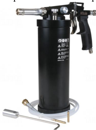
Рисунок 4.26 – Пістолет з бачком для виконання антикорозійного захисту кузова автомобіля.
