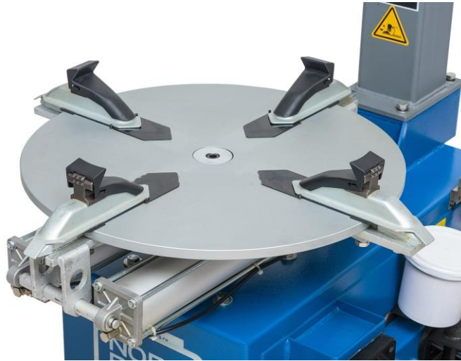
Рисунок 6.4 - Монтажный стіл для шиномонтажного станда із затискними кулачками.
