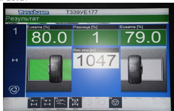
Рисунок 5.36 – Результати діагностування за методом EUSAMA.
