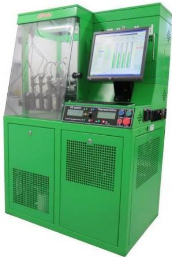
Рисунок 5.42 – Стенд для діагностування електроннокерованих форсунок системи живлення типу «Common Rail».
