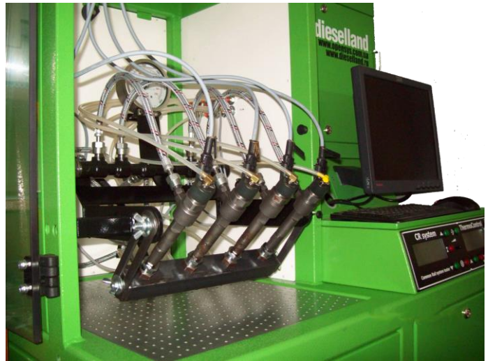
Рисунок 5.42 – Стенд для діагностування електроннокерованих форсунок системи живлення типу «Common Rail».
