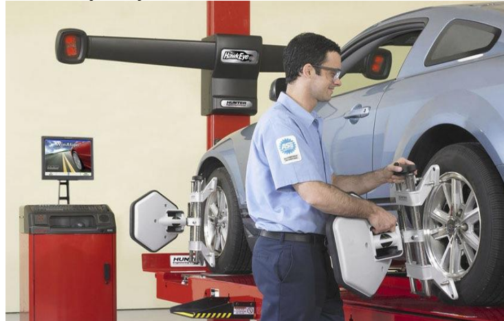
Рисунок 5.23 – Робота на стенді для контролю кутів встановлення коліс, що працює за 3D-технологією.
