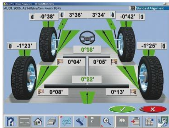
Рисунок 5.26 - Результат аналізу кутів встановлення коліс автомобіля.
