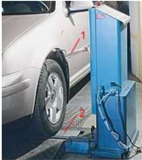
Рисунок 5.29 - Стенд для проведення шок тесту.
