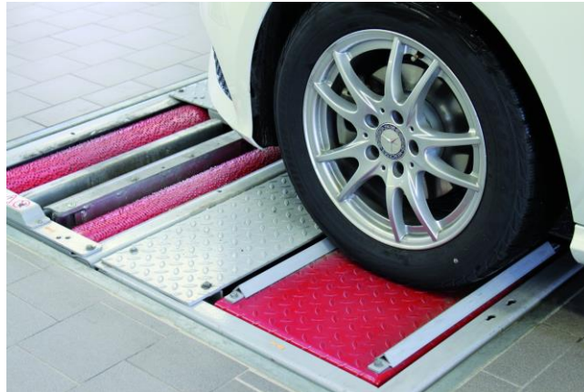
Рисунок 5.37 - Встановлення автомобіля на тестер підвіски.
