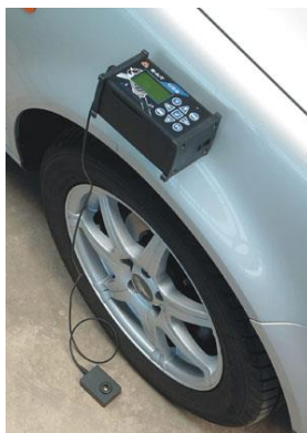
Рисунок 5.27 - Діагностування підвіски з використання датчика переміщень кузова.
