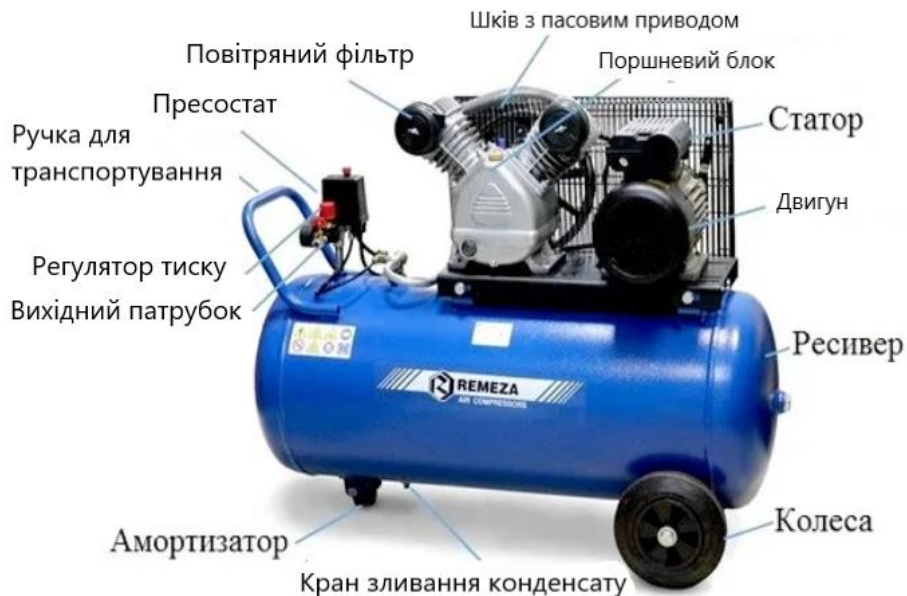
Рисунок 4.27 - Загальна будова поршневого електричного компресора.
