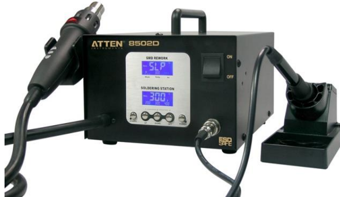
Рисунок 8.27 - Паяльна термоповітряна станція.
