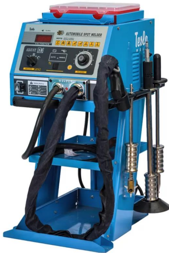
Рисунок 8.22 - Спотер для кузовного ремонту.
