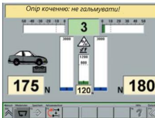
Рисунок 5.12– Зображення монітора при визначенні опору вільного кочення коліс автомобіля.
