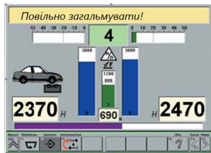
Рисунок 5.15 – Зображення монітора при визначенні гальмівної сили при приведенні в дію стоянкової гальмівної системи
