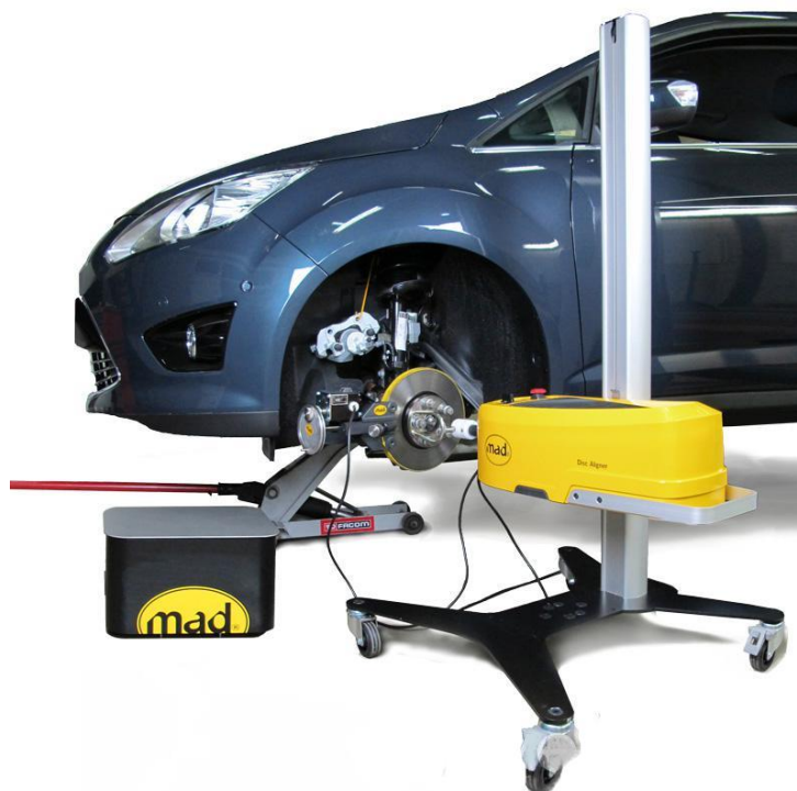
Рисунок 7.3 - Верстат для двосторонньої проточки гальмівних дисків легкових автомобілів.
