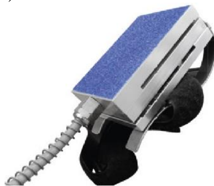
Рисунок 5.11 - Пристрій стенда для вимірювання зусилля на педалі гальм.
