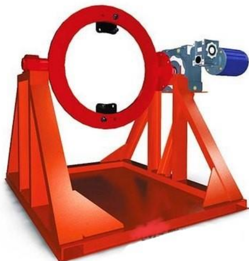
Рисунок 7.13 - Стенд для розбирання редукторів задніх мостів.
