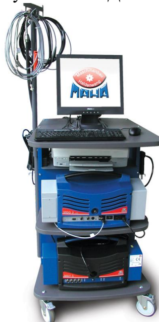
Рисунок 5.57 – Комбітестер (газоаналізатор+димомір) фірми МАНА модель MGT 5/MDO 2 LON.
