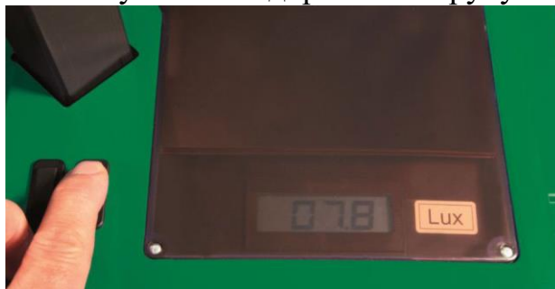
Рисунок 5.70 - Максимальне значення засліплення \leq 1,0 люкс для галогенного світла, \leq 1,3 люкс для ксенонового світла.
