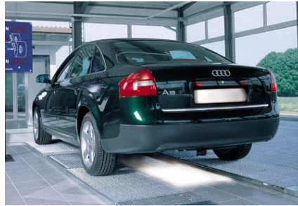
Рисунок 5.18 - Інерційний платформовий стенд.
