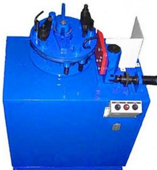
Рисунок 7.5 - Стенд для зрізання гальмівних накладок.
