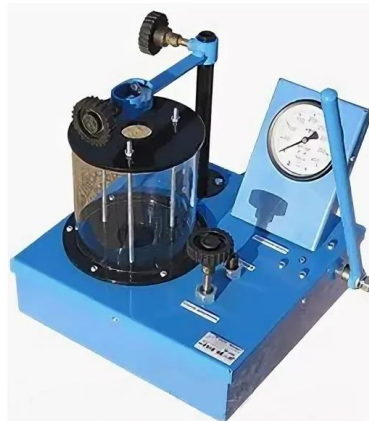
Рисунок 5.41 – Прилад для перевірки та регулювання механічних форсунок.
