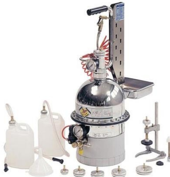
Рисунок 4.20 - Установка для заміни гальмівної рідини.
