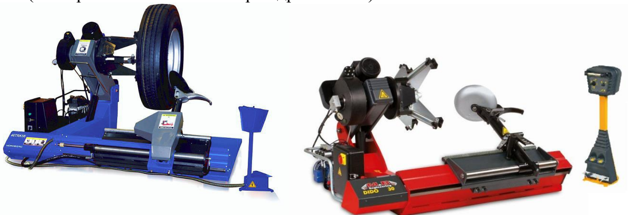
Рисунок 6.2 - Шиномонтажні стенди для демонтажу-монтажу коліс вантажних автомобілів.
