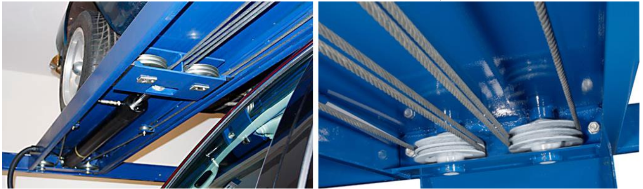
Рисунок 3.11 - Схема тросової синхронізації електрогідравлічного підйомника
