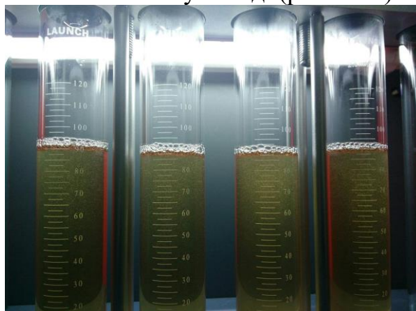
Рисунок 5.49 – Контрольна перевірка форсунок після ультразвукового очищення
