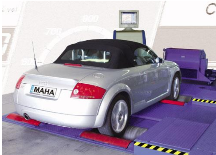
Рисунок 5.7 - Динамометричний стенд МАНА (Німеччина) модель LPS 3000
