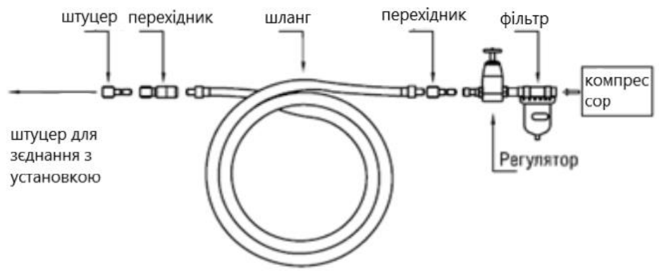
Рисунок 4.19 – Схема підключення установки для заміни гальмівної рідини до пневмолінії.
