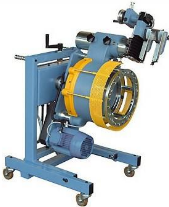
Рисунок 7.2 - Верстат TD 502 для проточування гальмівних дисків легкових автомобілів і барабанів коліс мікроавтобусів і невеликих вантажівок без зняття їх з автомобіля фірми СОМЕС (Італія).
