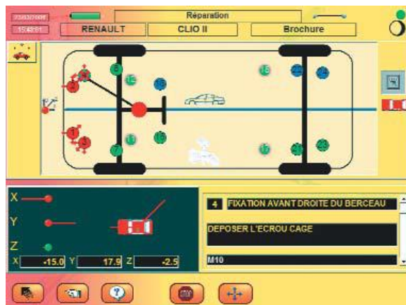
Рисунок 8.6 – Вимірювальний стенд NAJA з електронно-механічною системою (вимірювання — у полярній системі координат) фірми CELETTE (Франція).
