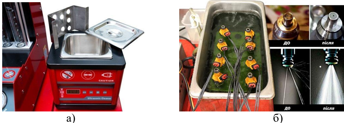
а) ванна ультразвукового очищення; б) очищення форсунок ультразвуком; Рисунок 5.48 - Ультразвукова ванна для очищення форсунок.
