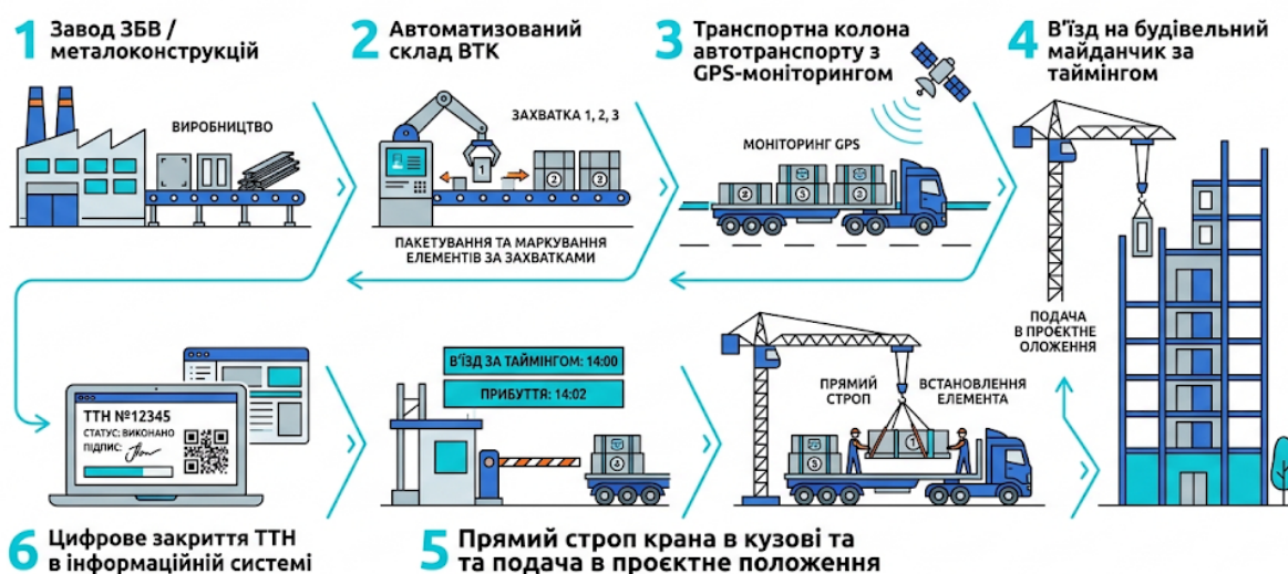
Рисунок 7.1 — Логістична схема постачання матеріалів за концепцією Just-in-Time
