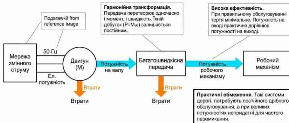
Рисунок 7.8 - Структурна схема перетворення енергії при використанні жорстких механічних передач
