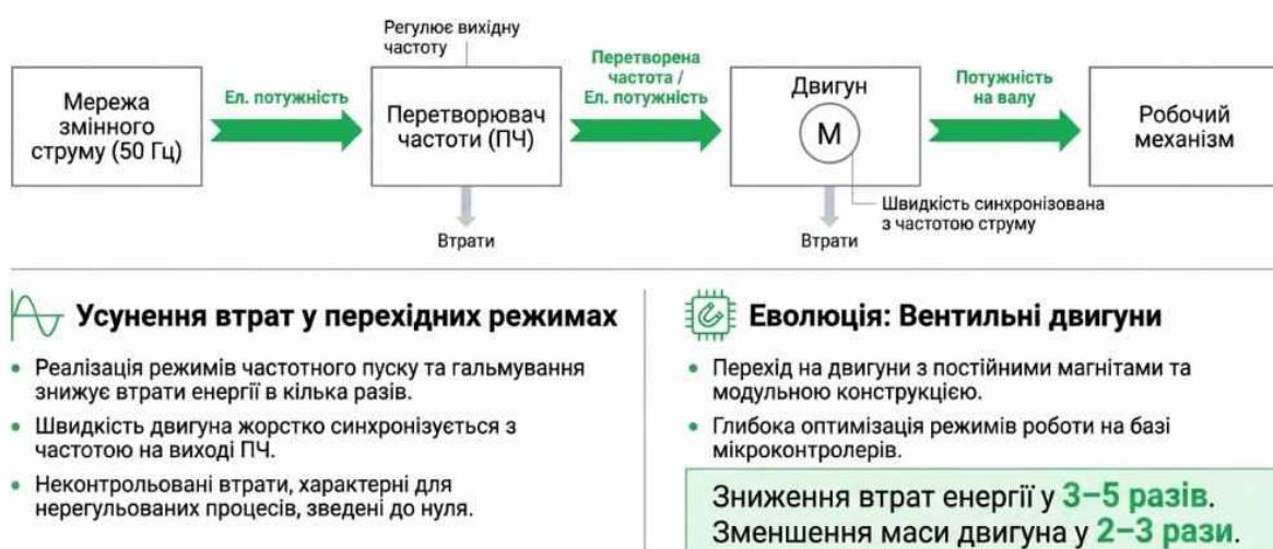
Рисунок 7.11 — Енергозбереження через частотне регулювання
