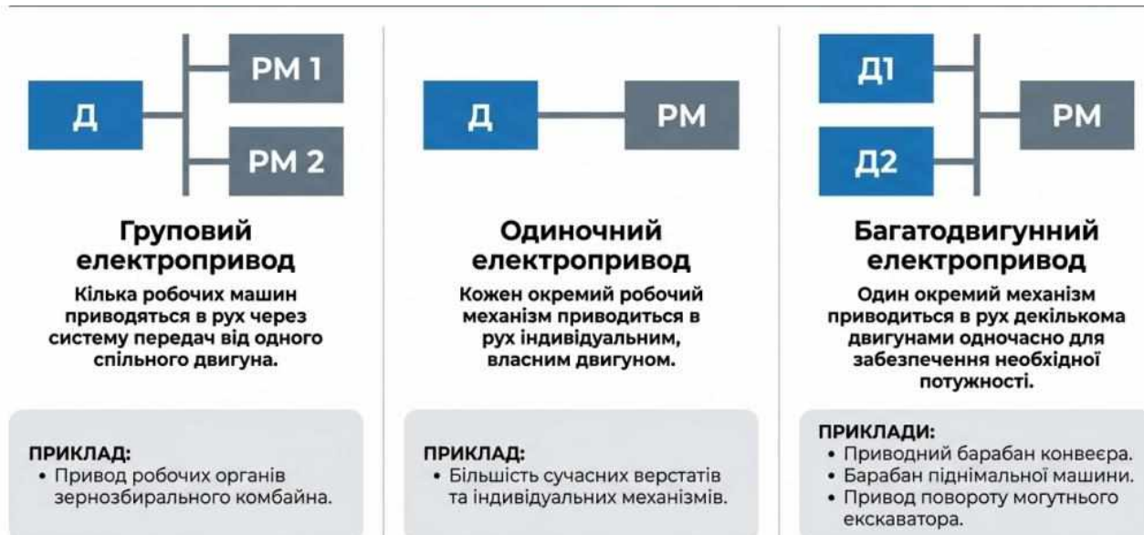
Рисунок 7.4 – Способи передачі механічної енергії від вала двигуна до робочого механізму
