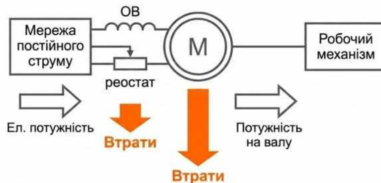
Рисунок 7.10 – Двигун постійного струму (ДПТ) незалежного збудження з регульованим реостатом. Керування здійснюється за рахунок збільшення втрат.
