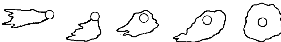
Рисунок 2.4 – Процес утворення ожеледної муфти на проводі ПЛЕ
