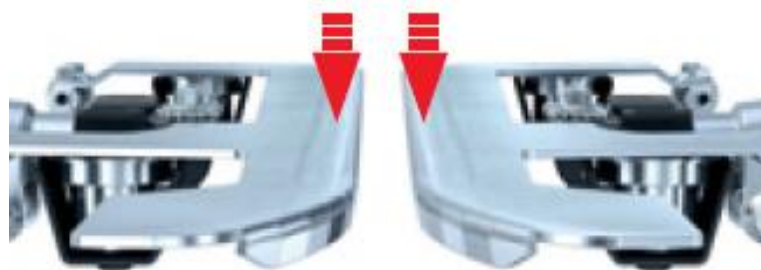
Рис. 2.16. Схема роботи відривних пластин жатки DragoGT
