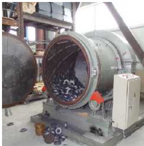
Рисунок 1.7 – Загальний вид дробометного барабану періодичної дії
