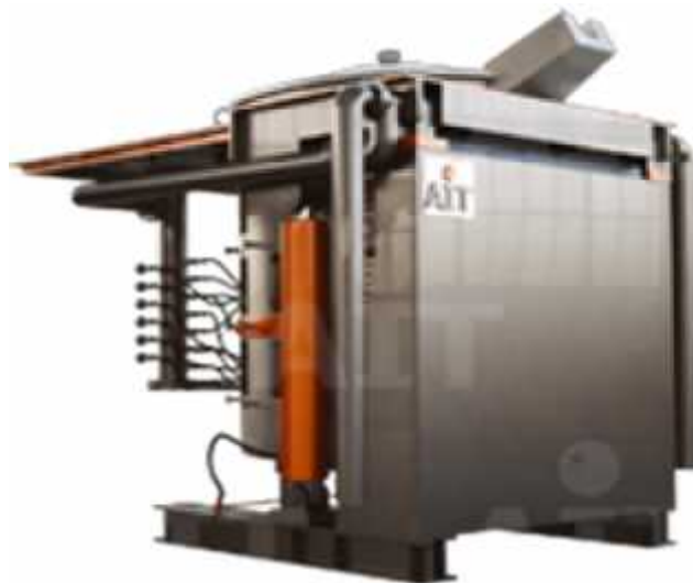
Рисунок 1.1. – Загальний вид тигельної індукційної печі ІЧТ-10,0
