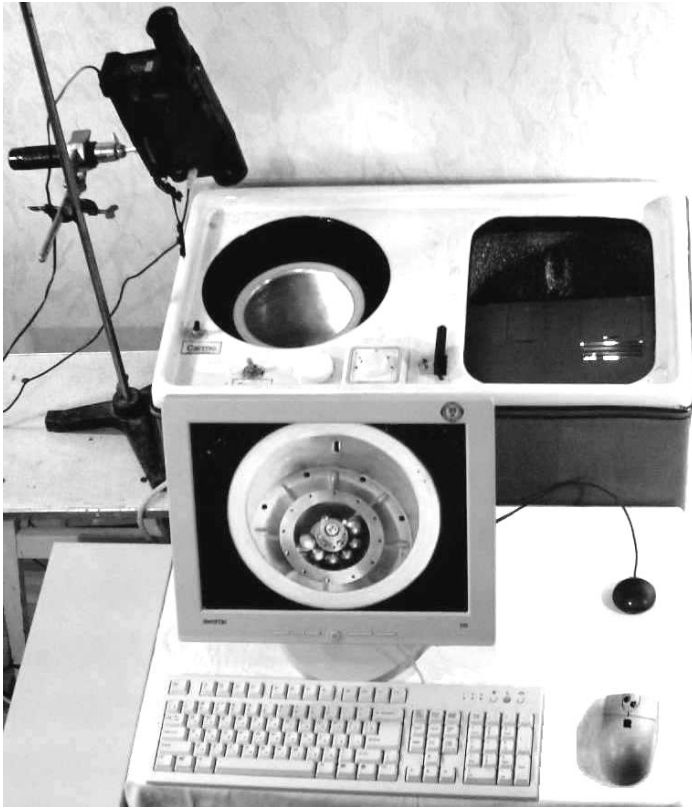
Рис. 4.2. Фотографія універсального стенда в конфігурації стенд, відеокамера, ПК
