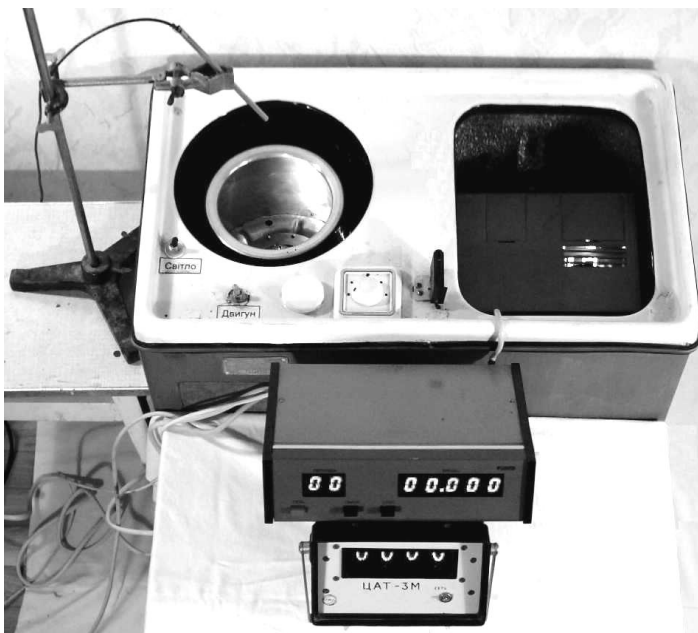
Рис. 4.1. Універсальний стенд для дослідження динаміки АБП: а - схема; б - фотографія (стенд, тахометр, лічильник імпульсів-секундомір)
