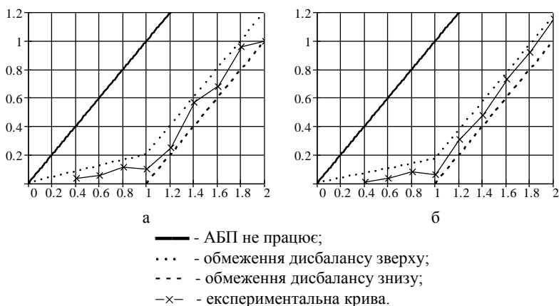
Рис. 5.11. Оцінка ефективності зрівноваження ротора кульовими АБП: а – в'язке, б – рідке мастило
