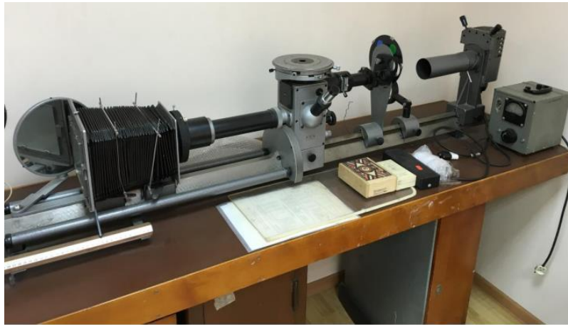
Рисунок 3.8 – Загальний вид металографічного мікроскопу МІМ-8
