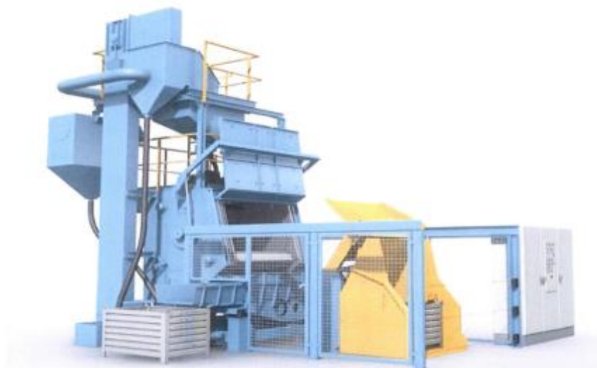
Рисунок 1.7– Схема дробометної установки.
