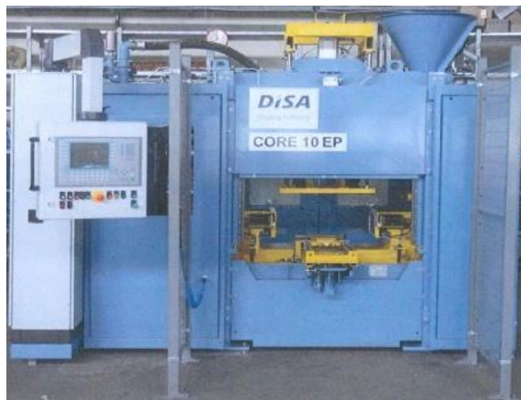
Рисунок 1.4 – Машина для виготовлення стержнів DISA CORE 10 EP
