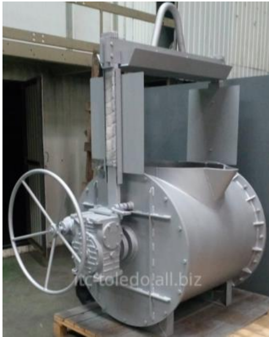
Рисунок 1.2 – Загальний вид барабанного ковша для чавуну
