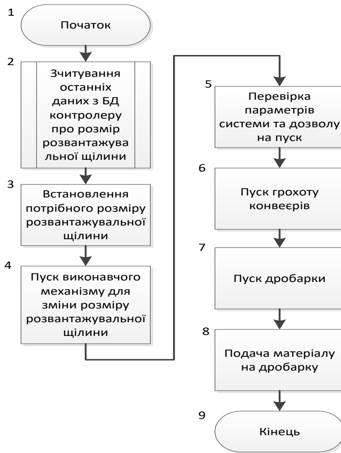
Рисунок 3.18 - Блок-схема алгоритму пуск тракту дроблення
