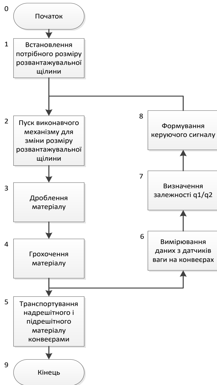
Рисунок 3.21 - Блок-схема алгоритму зміни розміру розвантажувальної щілини для Simmons CSB75
