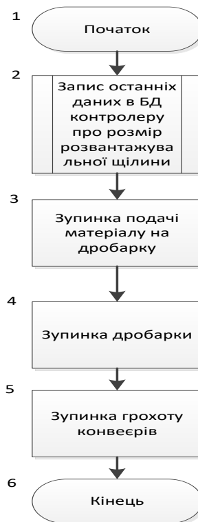
Рисунок 3.19 - Блок-схема алгоритму вимкнення тракту дроблення
