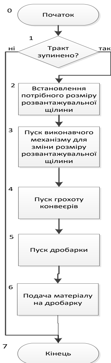
Рисунок 3.20 - Блок-схема алгоритму зміни розміру розвантажувальної щілини для КСД1650
