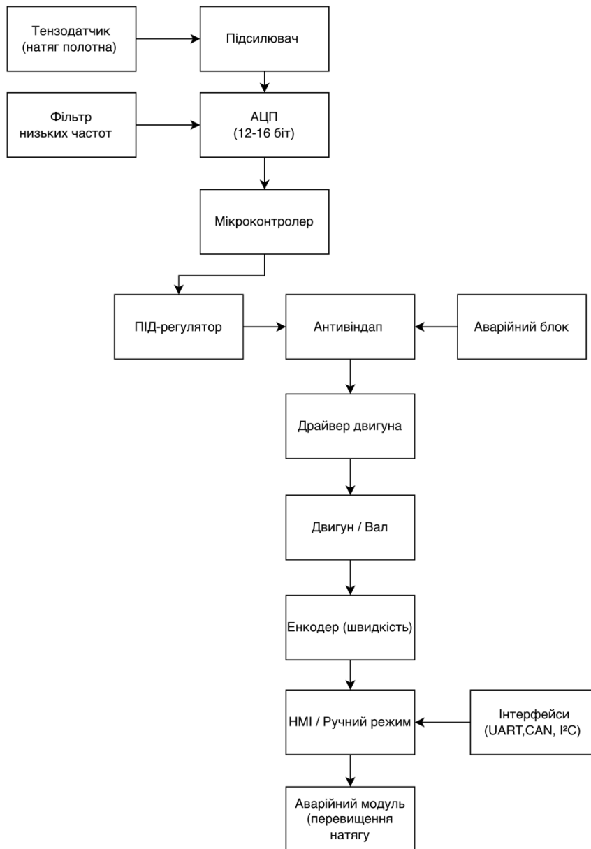
Рисунок 5.4 - Схема практичної реалізації системи стабілізації натягу
