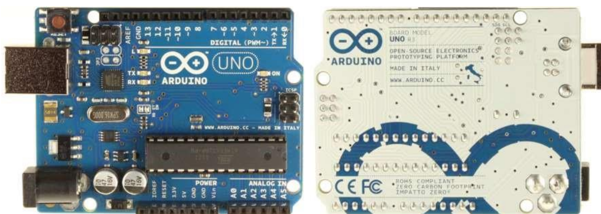
Рисунок 3 – Загальний вигляд плати Arduino Uno
