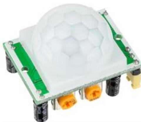
Рисунок 3.7 – Датчик руху HC-SR501
