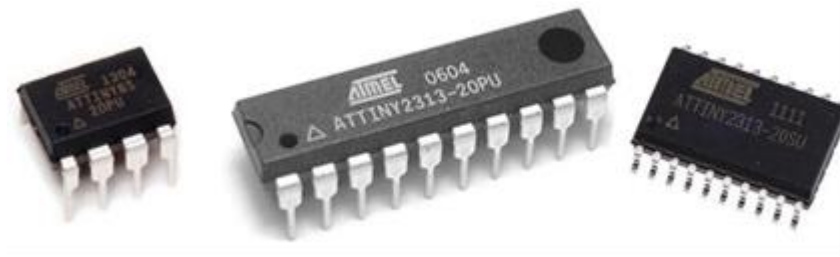
Рисунок 1.2 – Мікроконтролери серії AVR
