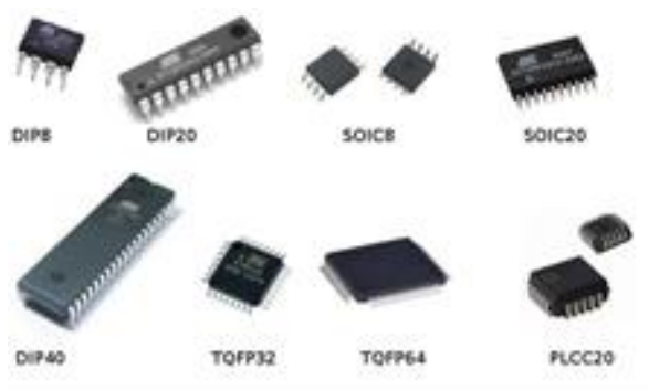
Рисунок 1.1 – Мікроконтролери та їх типи
