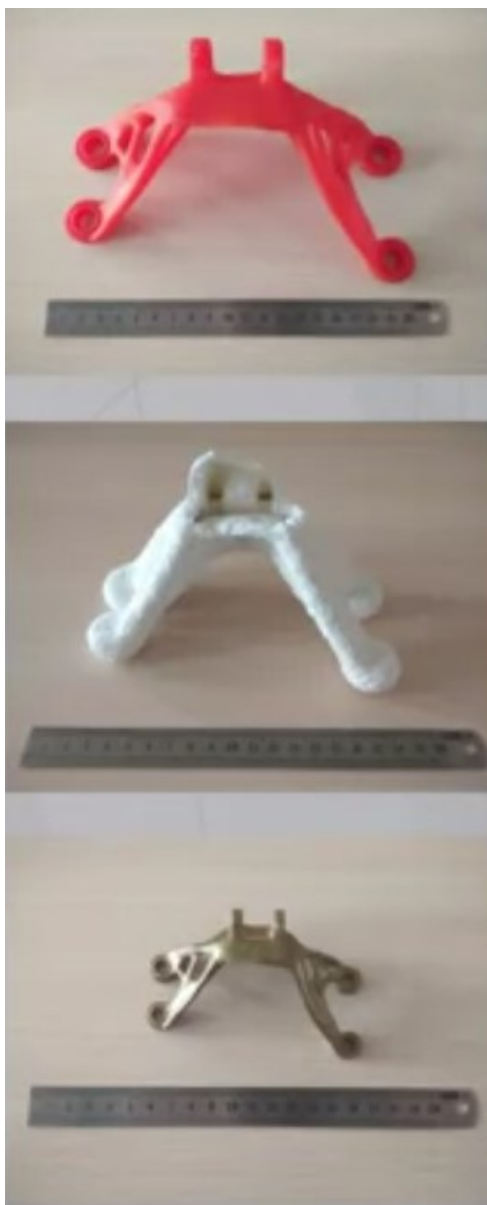
Рисунок 3.7 - Етапи виробництва виливків із застосуванням адитивних технологій SLA 3Д друку
