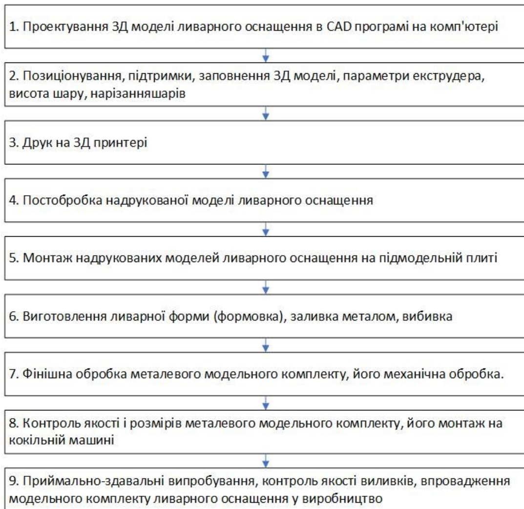
Рисунок 3.9 - Блок-схема процесу проектування і виготовлення ливарного оснащення із застосуванням адитивних технологій
