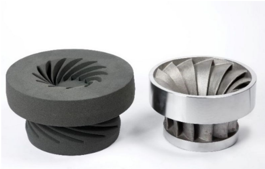
Рисунок 3.8 – Надрукована на 3Д принтері ливарна форма і виливок
