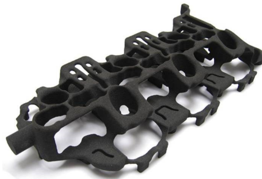
Рисунок 3.8 – Надрукований на 3Д принтері піщаний стержень
