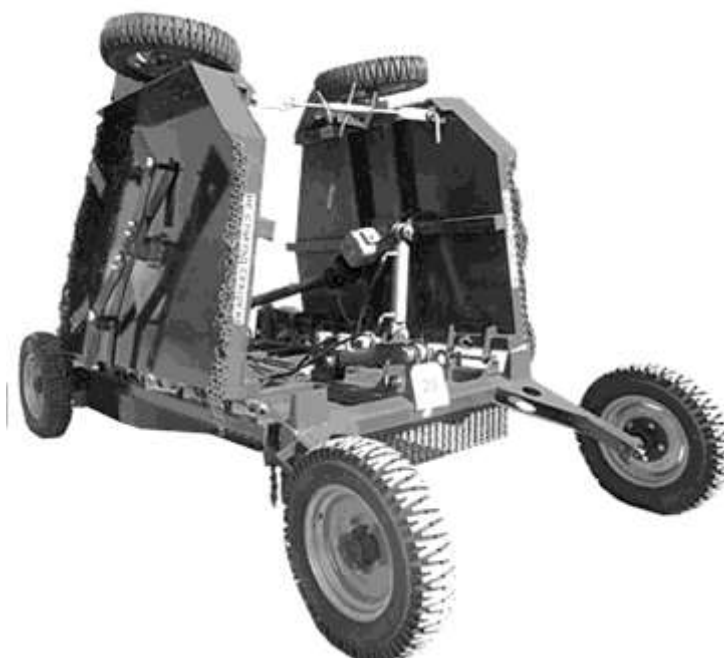
Рис. 5. Загальний вигляд подрібнювача рослинних решток ПРН-4,5 з вертикальною віссю обертання робочих органів
