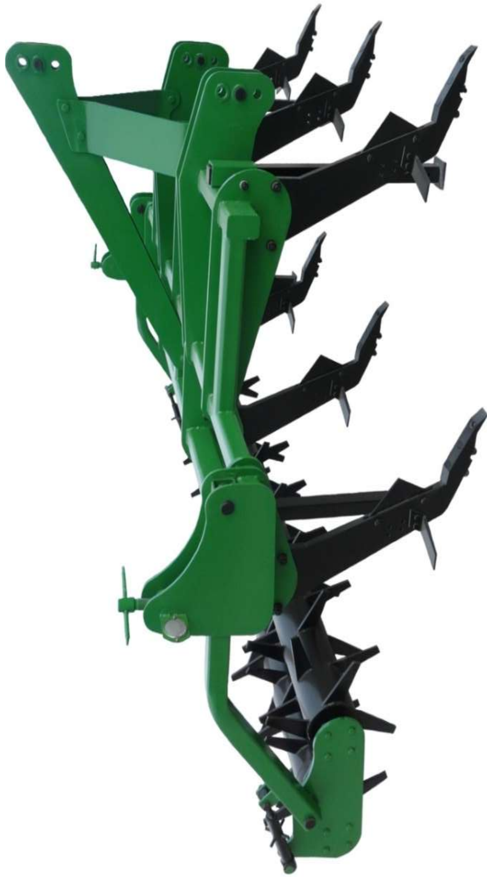
Рис. 3. Чизельний глибокорозпушувач. Випускається в чотирьох модифікаціях: – шириною захвату – 1,5; 2,5; 3,5; та 4,5 м. (Розробники конструкції : Сало В.М., Лещенко С.М.)
