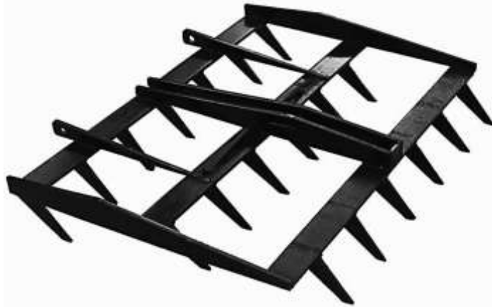
Рис. 68. Загальний вигляд борони з плоскими зубами та тупим кутом входження в ґрунт
