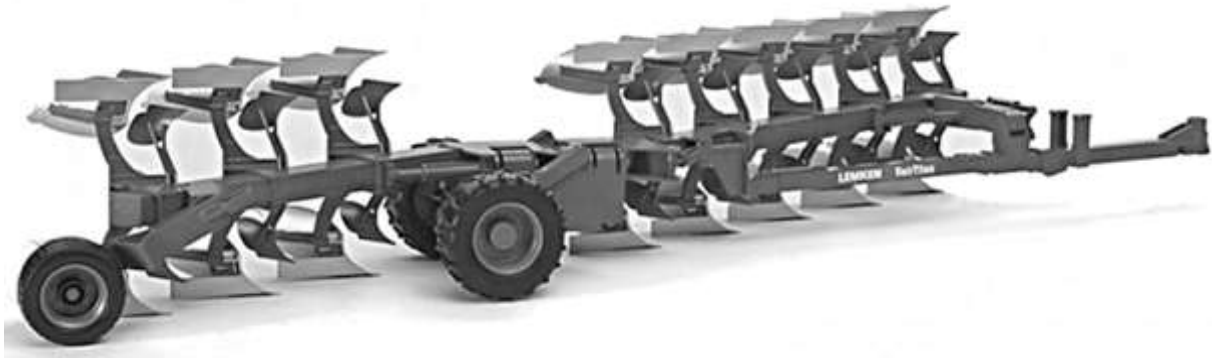
Рис.2. Загальний вигляд оборотних плугів з роз'ємною рамою
