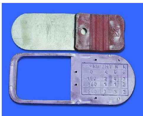
Рисунок 3.6. – Контрольний щуп для визначення величини теплового зазору в приводі клапанів
