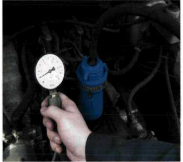
Рисунок 2.14 - Вимірювання тиску в порожнині картера ДВЗ з відкритою а) та закритою б) системою вентиляції картера.
