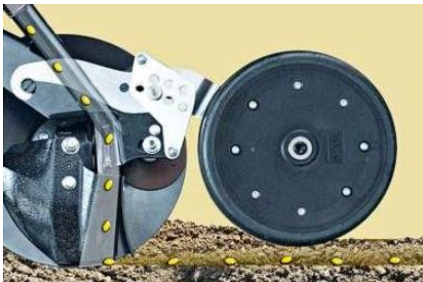
Рис. 3.2 Конструкція однодискового сошника овочевої сівалки
