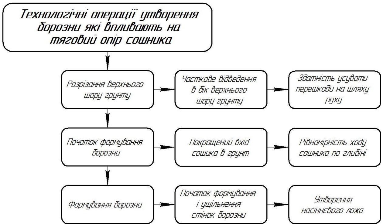
Рис. 3.5 Технологічні операції утворення борозни які впливають на тяговий опір сошника
