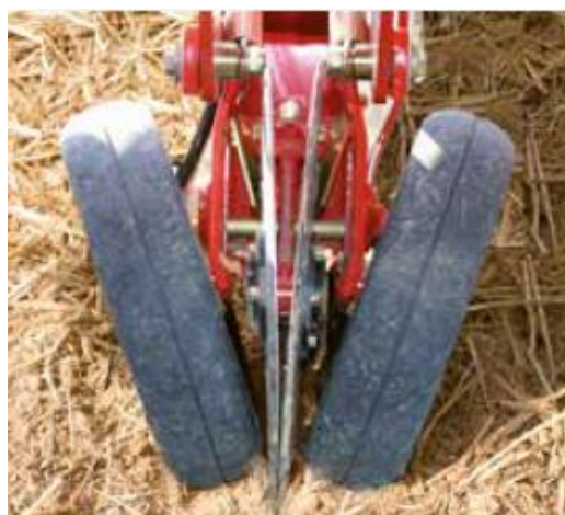
Рис. 3.3 Конструкція дводискового сошника овочевої сівалки
