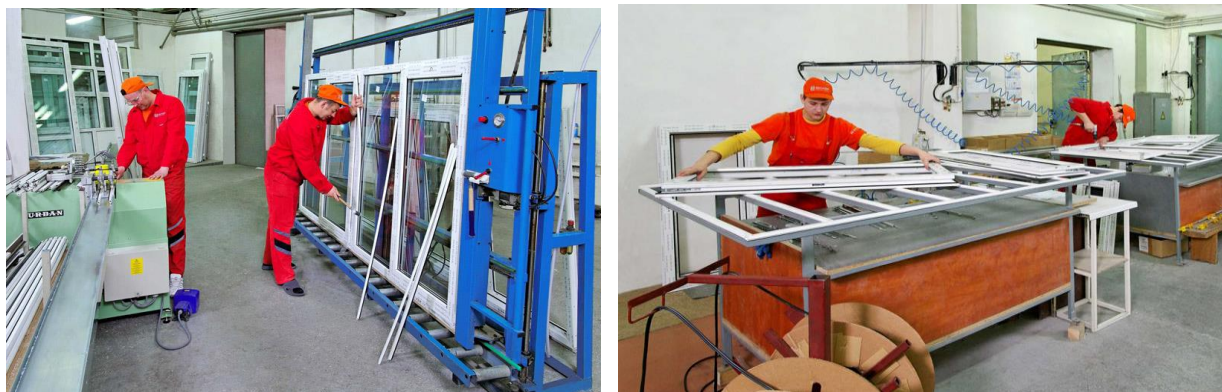
Рис. 2.4 – Лінія з виробництва метало-пластикових вікон
