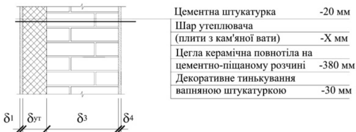
Рисунок 2.1 – Конструкція зовнішньої стіни.
