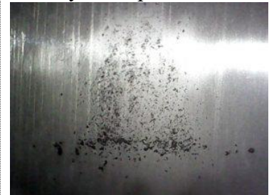
Зношене покриття циліндра двигуна БМВ
