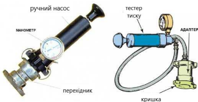
Рисунок 8.3 - Перевірка тиску спрацювання клапанів у кришці радіатора (розширювального бачка).
