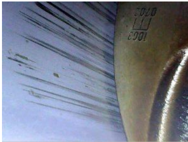
Здертий шар покриття циліндра двигуна Мерседес
