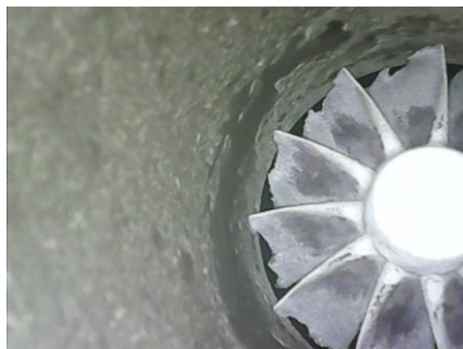
Рисунок 3.5 – Руйнування крильчаток турбіни турбокомпресора
