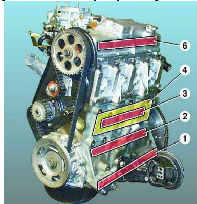
Рисунок 2.2. – Зони прослуховування двигуна: 1 – стук корінних підшипників; 2 – стук шатунних підшипників; 3 – стук поршневих пальців; 4 – стук зношених поршнів та циліндрів; 5 – детонаційні стуки; 6 – стук клапанів.
