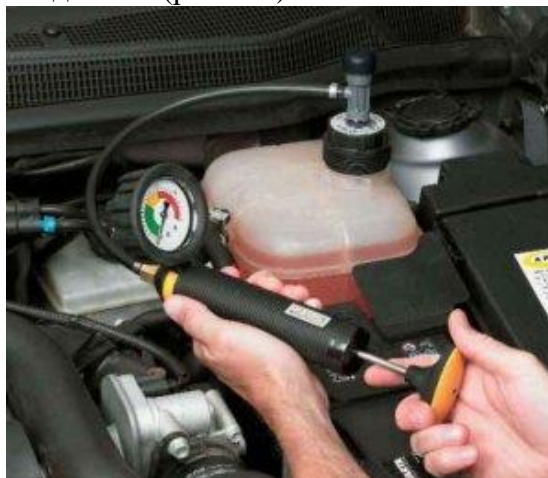
Рисунок 8.2 - Опресовування системи охолодження
