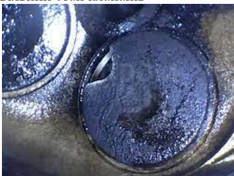
Поломка тарілки клапана
