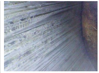
Задирання в циліндрі двигуна Мерседес ML
