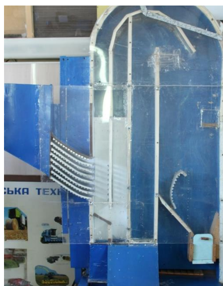
Рис. 3.4 Загальний вигляд експериментальної установки для дослідження пневмоканалу з розподільчим пристроєм.
