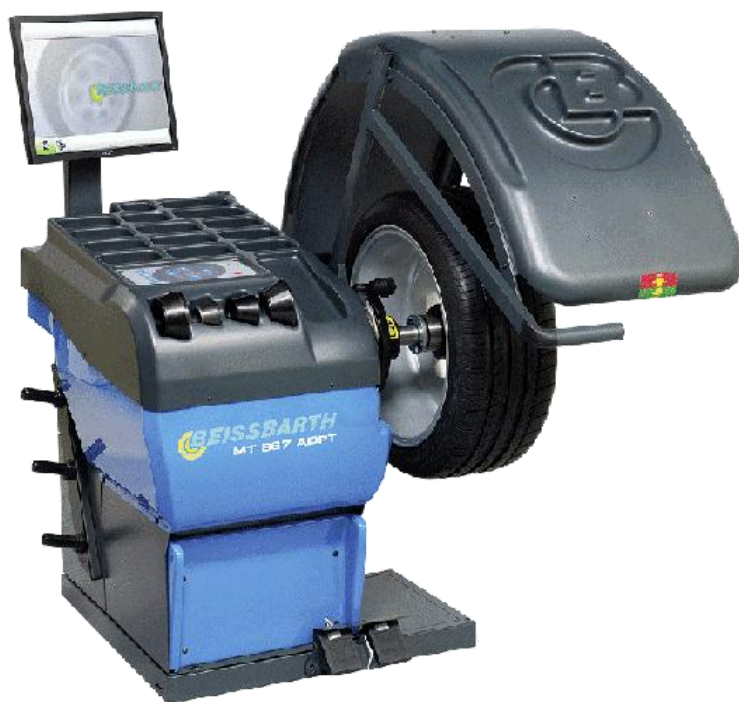
Рис.2.2. Стенд діагностичний мод. МТТ 2020 (розробник – компанія Beissbarth)
