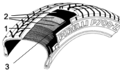
Рис.4.4. Будова радіальної шини з металокардом: 1 – протектор; 2 – брекер з декількох шарів нейлонової тканини (зверху) і металокарду (знизу); 3 – радіальні нитки металокардного каркасу
