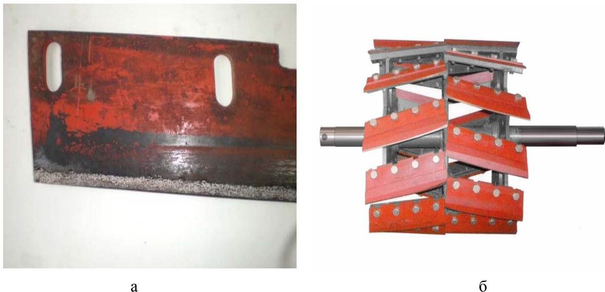
Рисунок 3 – Нож (а) измельчающего барабана (б) комбайна
