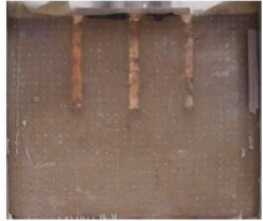
Рисунок 2.5 Фото основи плитно-палевого фундаменту з опресовуванням при навантаженні N=10\text{кН} ( P_{\text{ср}}=111\text{ кПа} )
